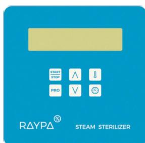
**Programmes** – Le microprocesseur dispose de 10 programmes, numérotés de P0 au P9. P0 – P3 sont protégés et configurés d'usine.
