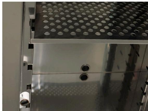
TRous LATÉRAUX ET ARRIÈRE POUR L'ÉVACUATION DE L'HUMIDITÉ GÉNÉRÉE DANS LA CHAMBRE ET EN TANT QUE PORT D'ACCÈS POUR UNE SOnDE EXTÉRIEURE
